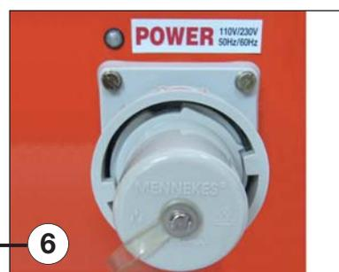
Alimentation à 110V/230V CA pour charger la batterie à 40 Ah.
