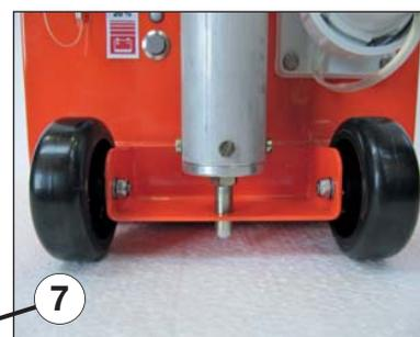
Cheville de fixation inférieure pour fixer le mât rapidement et facilement au coffre de la batterie/chargeur. Aussi équipé de roues roulantes pour se déplacer plus facilement.
