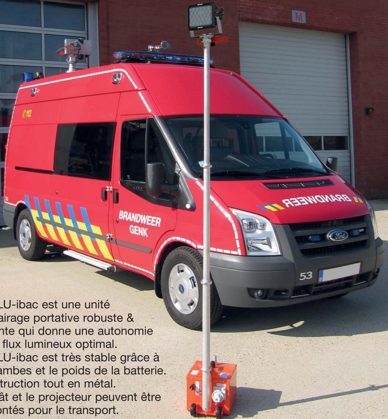
Le RLU-ibac est une unité d'éclairage portative robuste & roulante qui donne une autonomie et un flux lumineux optimal. Le RLU-ibac est très stable grâce à ses jambes et le poids de la batterie. Construction tout en métal. Le mât et le projecteur peuvent être démontés pour le transport.
