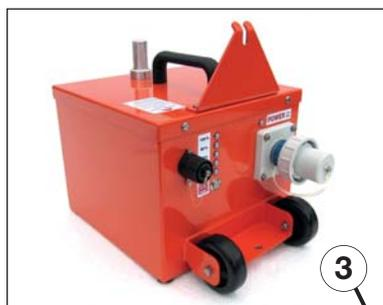
Coffre de batterie avec chargeur à microcontrôleur intégré, prise 110/230 volts CA, fiche 12 volts CC, poignée et des jambes pliantes, y compris une batterie rechargeable sans entretien de 12 volts 40 Ah.
