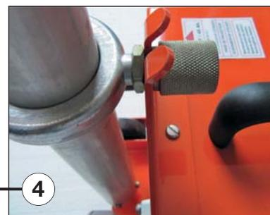
Montage du mât au coffre de la batterie/chargeur est serré par un seul écrou moleté.
