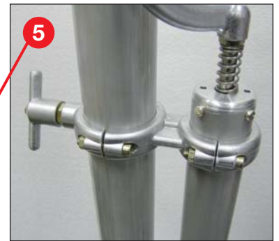
Handpumpe und Befestigungsschraube für schnelle und einfache Befestigung am Dreibeinstativ
