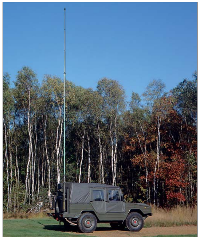
Foto: PU Mast am Fahrzeug montiert, unabgespannt.
