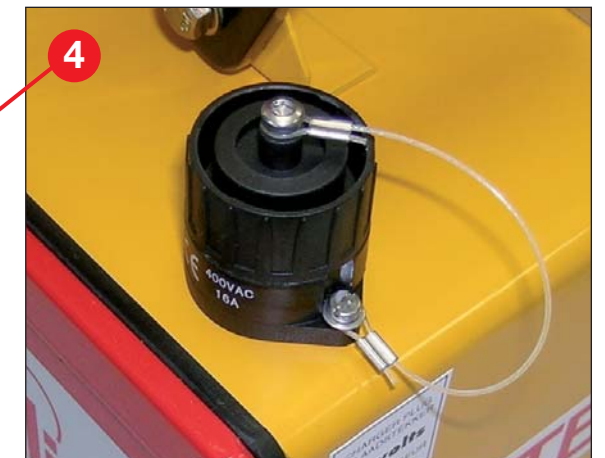
Binder Steckdose für das Teklite Ladegerät um die 12 Volt 12 Ah Batterie aufzuladen. Lackierung : Gelb RAL 1007 Rot RAL 3000
