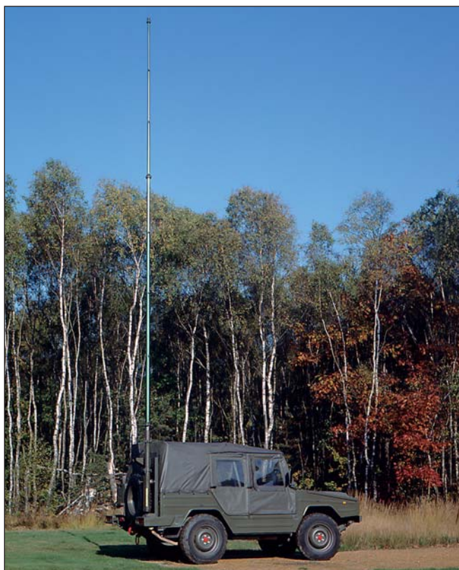
Foto: PU mast gemonteerd op voertuig, ongetuid.
